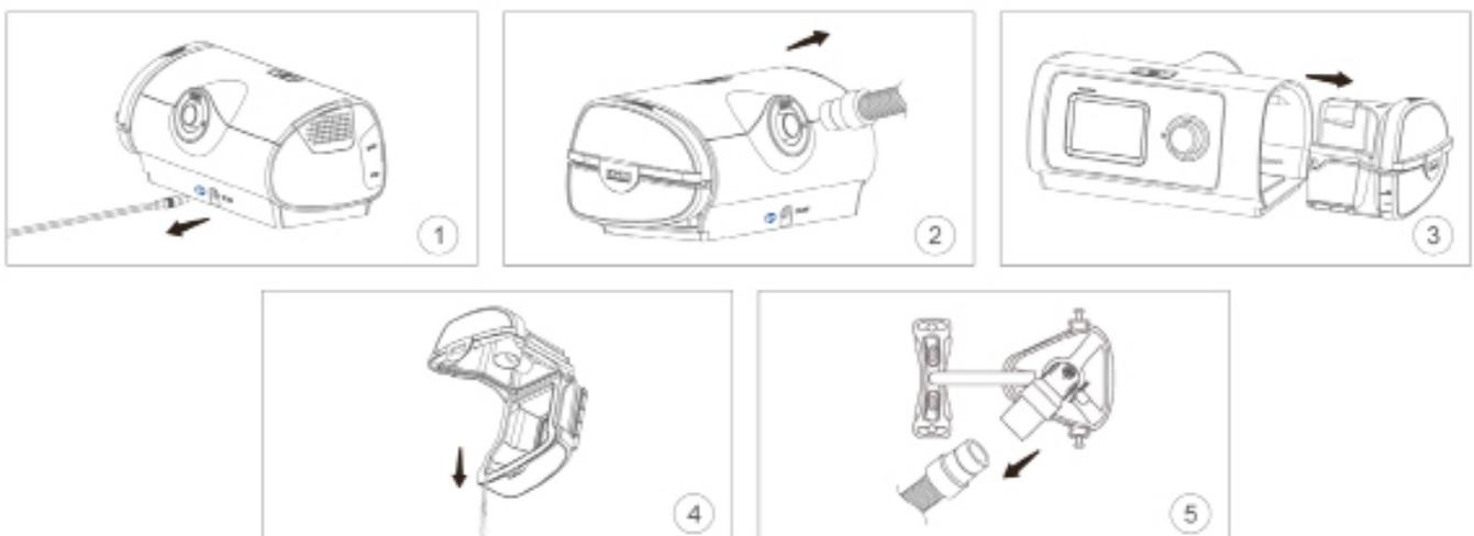
1. Tire o cabo de energia da tomada e desconecte da parte traseira do dispositivo.
